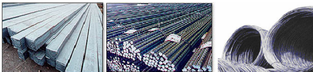
Figura 6: De Izq. a Derecha: Palanquillas. Barras. Alambρόn
