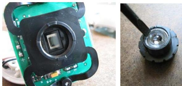
Figura 3.4: Ubicación del sensor de luz y lente que contiene filtro
