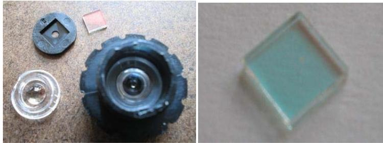
Figura 3.5: Extracción del filtro de luz infrarroja
