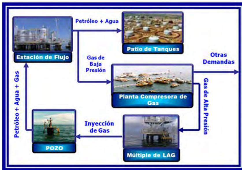
Figura 2.4: Proceso de Producción de Crudo asistido con LAG.
