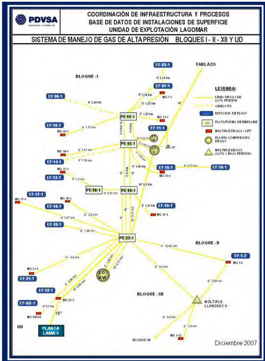
Figura 2.5: Sistema de Manejo de Gas de Alta Presión.
