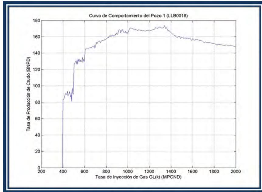
Figura 4.1: Tasa de Inyección de Gas GL(k) vs Tasa de Producción BN(k) del pozo 1 (LLB0018)
